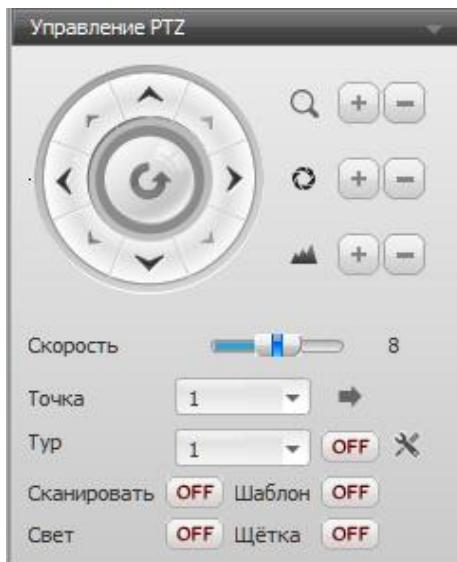
С помощью данного интерфейса осуществляются настройки направления, масштабирования, фокуса и диафрагмы PTZ камеры.
